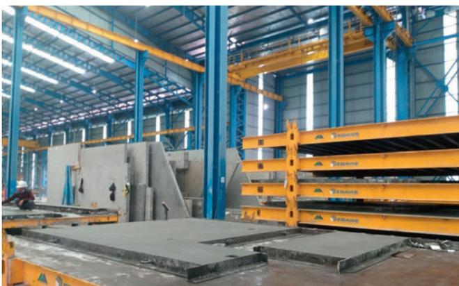
Die Massivdecken und -wände sind bereits mit einer Bewehrung versehen und bereit für den Transport und den Einbau auf der Baustelle.
