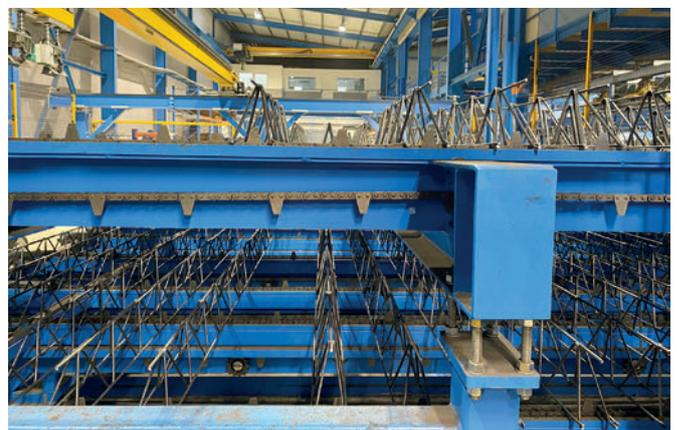
Alle gefertigten Gitterträger werden mittels Kranroboter auf einem Puffermagazin abgelegt, das diese dann automatisch und vereinzelt dem Verlegeroboter zuführt.
