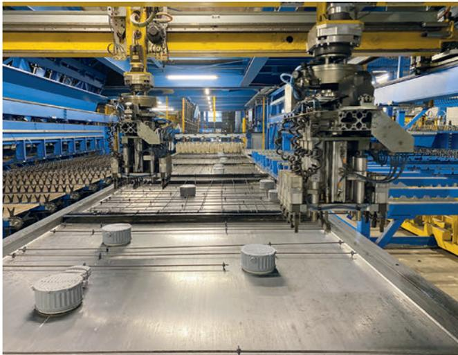
Mehrachsenroboter zur Platzierung der Bewehrung
