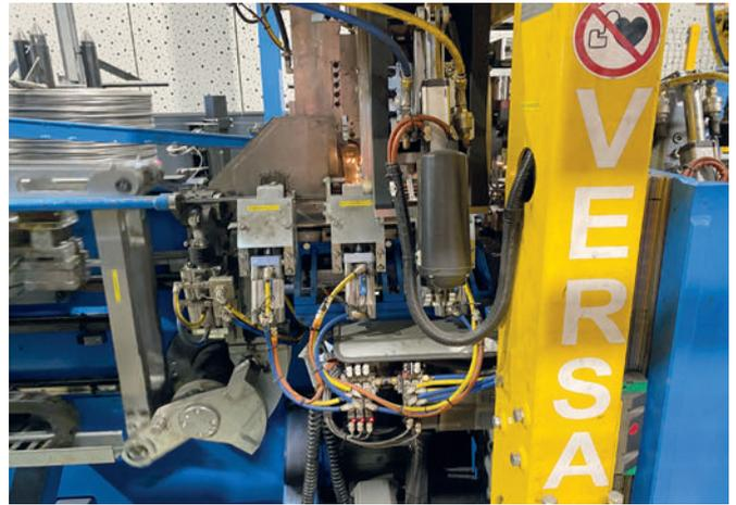
Gitterträgerschweißanlagen VGA Versa für eine flexible Produktion von Gitterträgern vom Coil
