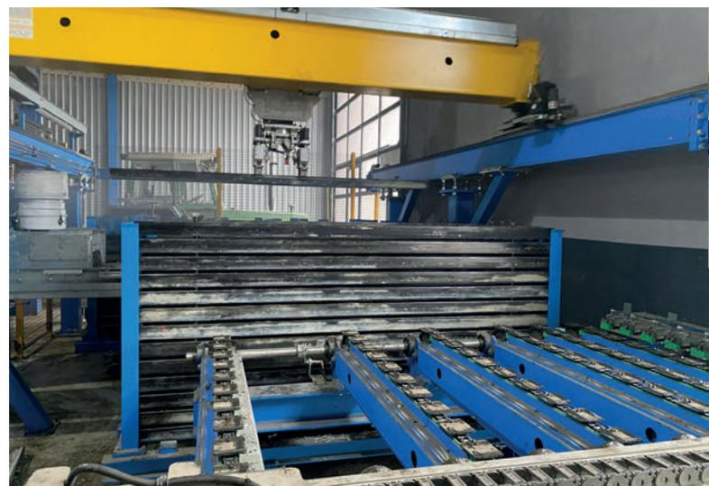
Lagerroboter im Aktivlager
