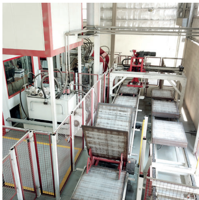
Поперечный конвейер с устройством для поворота поддонов (I) и буферным конвейером для поддонов; на заднем плане – магнитное устройство для укладки поддонов
