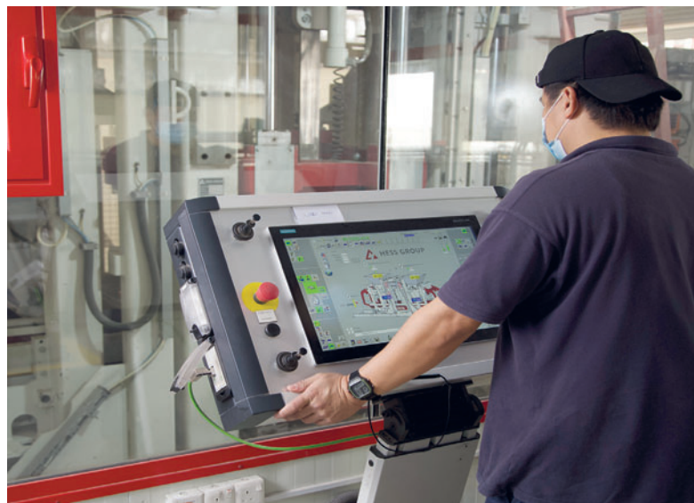
Как и все бетоноформовочные машины, выпускаемые группой компаний Hess, Multimat RH 1500-4, установленная на заводе Artic, оснащена пультом управления
