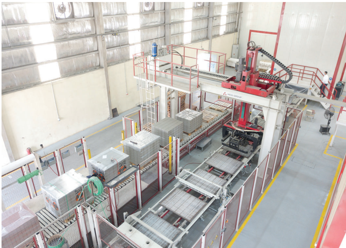
Брикеты с блоками укладываются на ленточный конвейер длиной 28 м
