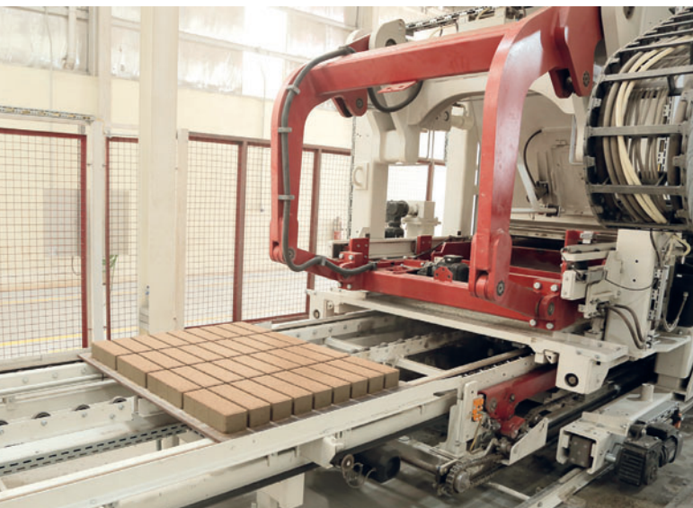
На новой линии в Artic используются стальные поддоны размером 1400 x 1100 x 14 мм
