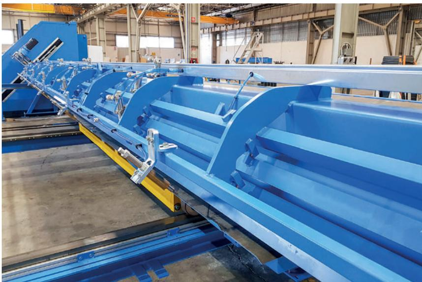
Механизм выгрузки продольных прутков с 2 выпускными заслонками и длиной 10 м захватывает отрезанные прутки и укладывает их в положение для дальнейшей транспортировки на станцию автоматизированной сварки
