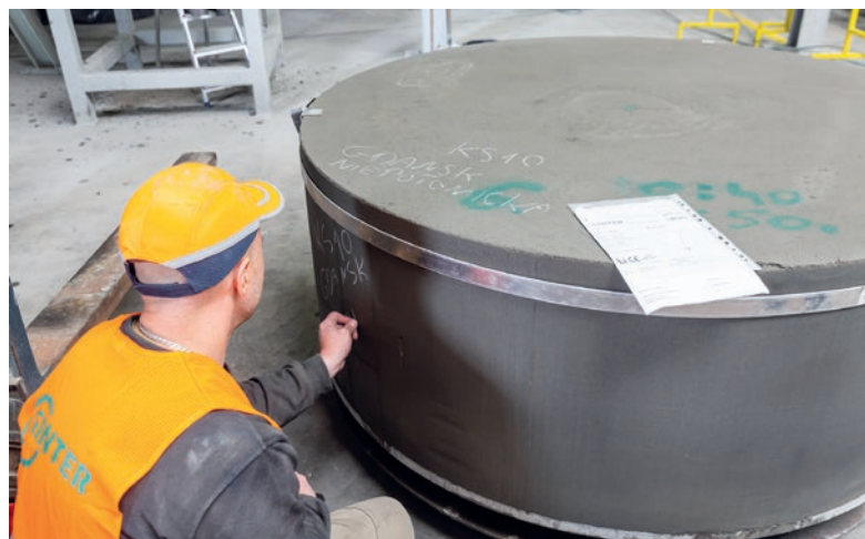
Już po dwóch godzinach od wyprodukowania element może być frezowany.
