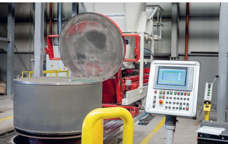
Podstawa studzienki po rozformowaniu, jeszcze przed obróbką.
