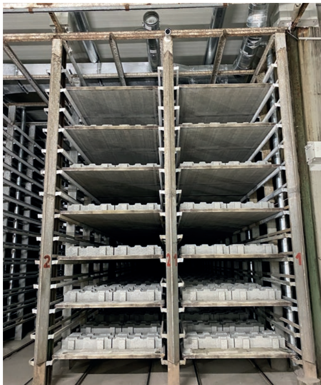
Wyroby z dolnej i górnej części regału nie wykazują już różnic w kolorze.
