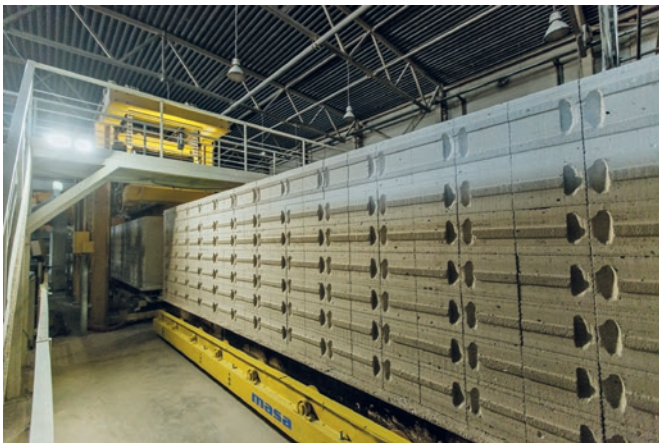
Produkcja bloczków silikatowych za pomocą prasy hydraulicznej Masa HDP 800.
