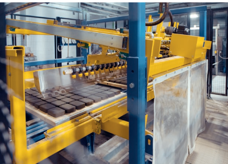
Stanowisko Masa do płukania kostki brukowej na linii mokrej.
