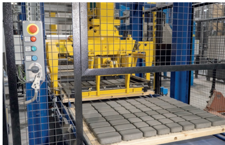
Centrownik Masa z napędem serwo i czterostronnym chwytkiem centrującym.
