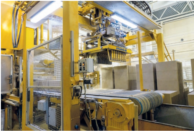
Produkcja bloczków silikatowych za pomocą prasy hydraulicznej Masa HDP 800.
