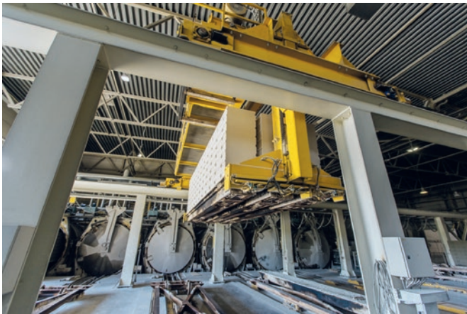
Impresje: Linia technologiczna Masa do produkcji bloczków z betonu komórkowego.
