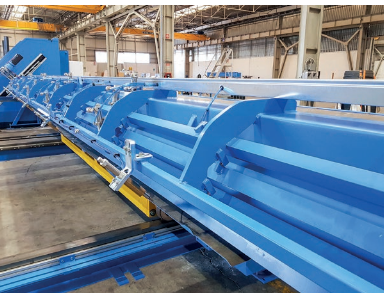
Linia odbiorcza prętów podłużnych z dwoma zasiekami o długości 10 m gromadzi pocięte pręty i ustawia je w odpowiedniej pozycji do dalszego automatycznego transportu na stanowisko zgrzewania.
