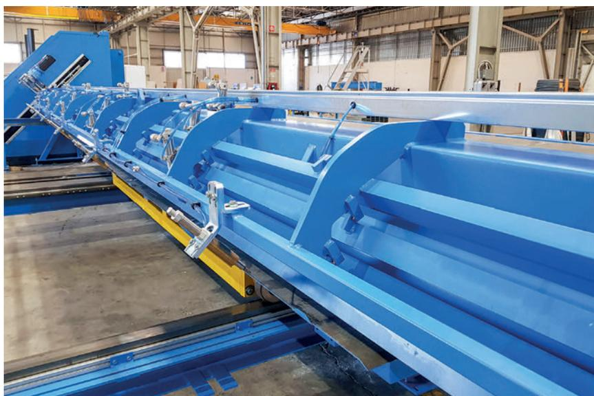
*Lo scarico del ferro longitudinale con 2 portelli di scarico e 10 m di lunghezza raccoglie le barre tagliate e le posiziona per continuare il trasporto, anch'esso automatizzato, verso la saldatura.*
