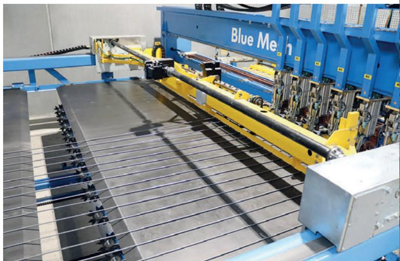
L'impianto di produzione di reti elettrosaldate salda reti di armatura just-in-time e secondo specifiche.
