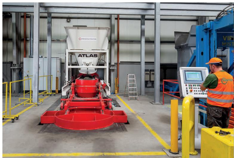
Atlas, l'impianto flessibile per la produzione di manufatti per pozzetti
