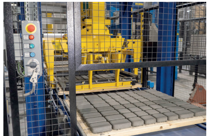
Dispositivo di centratura servoassistito Masa con pinza di centratura a 4 lati
