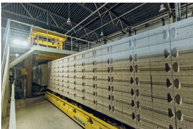
Produzione di blocchi di arenaria calcarea con la pressa idraulica Masa HDP 800
