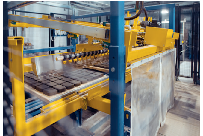
Impianto Masa per il lavaggio masselli sulla linea dell'umido
