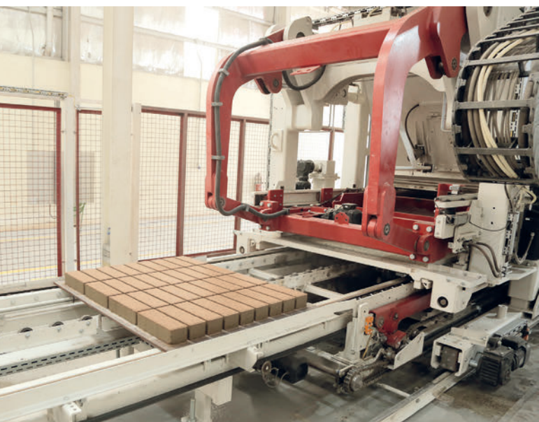
La produzione avviene su pannelli di acciaio di 1.400 x 1.100 x 14 mm.
