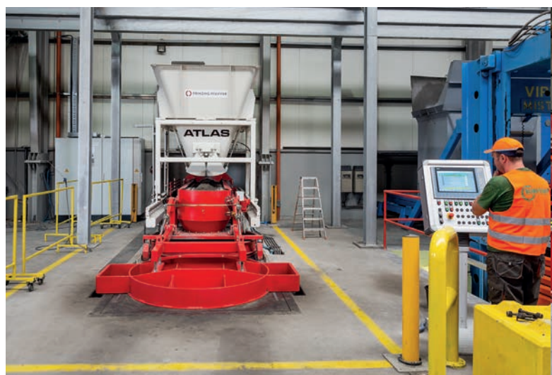
L'installation de production flexible Atlas pour la fabrication de produits de regards
