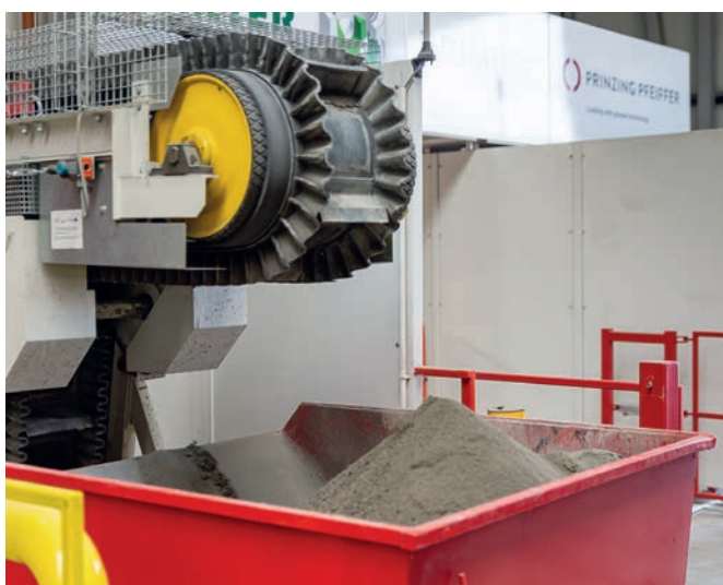
Les matériaux résiduels sont transportés vers le haut et peuvent être réutilisés dans la production
