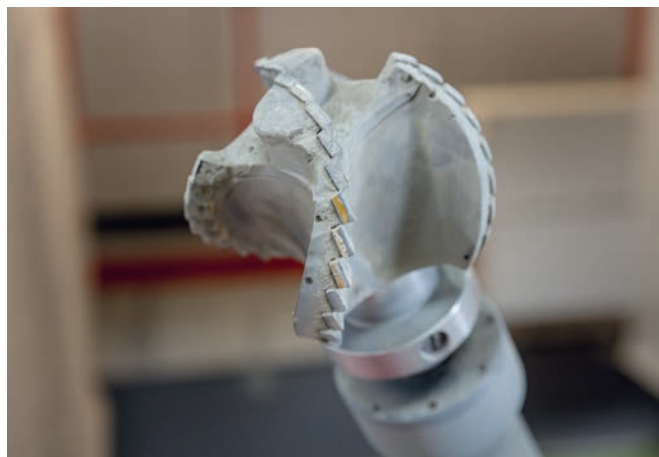
Fraisage du béton au millimètre près avec 2 têtes de fraisage différentes : à droite pour le canal et à gauche pour les entrées et les sorties
