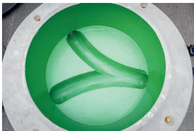
Fraisage du béton au millimètre près avec 2 têtes de fraisage différentes : à droite pour le canal et à gauche pour les entrées et les sorties
