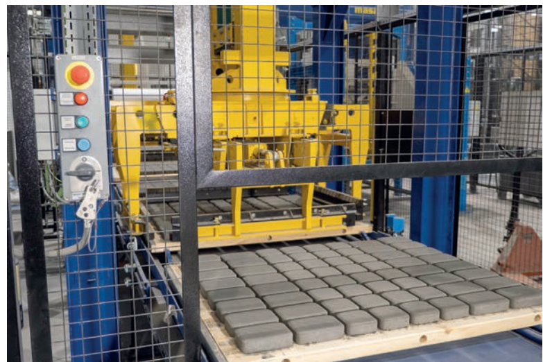
Dispositif de centrage Masa servocommandé avec pince de centrage à 4 faces
