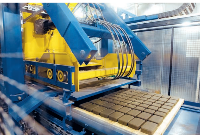
Machine de production de blocs Masa XL 9.1
