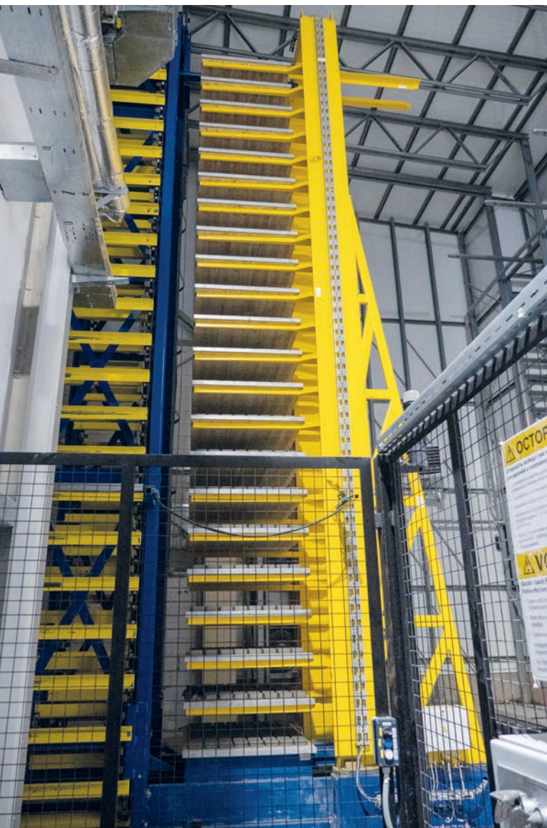
Procédé de travail continu avec le chariot transbordeur tampon Masa du côté sec
