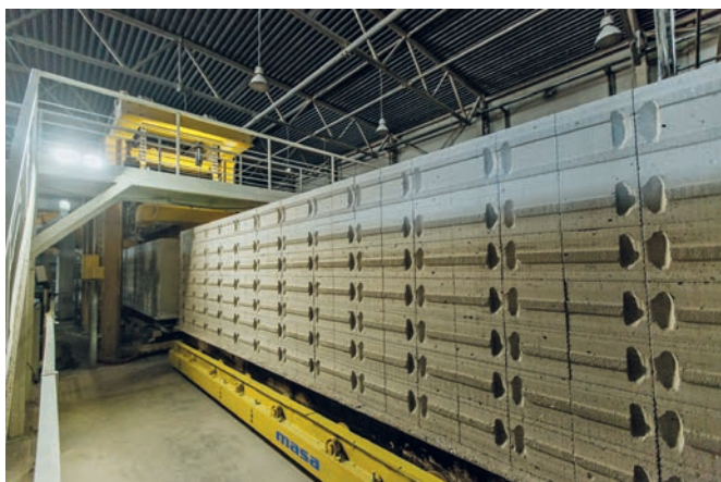
Production de briques silico-calcaires avec la presse hydraulique Masa HDP 800
