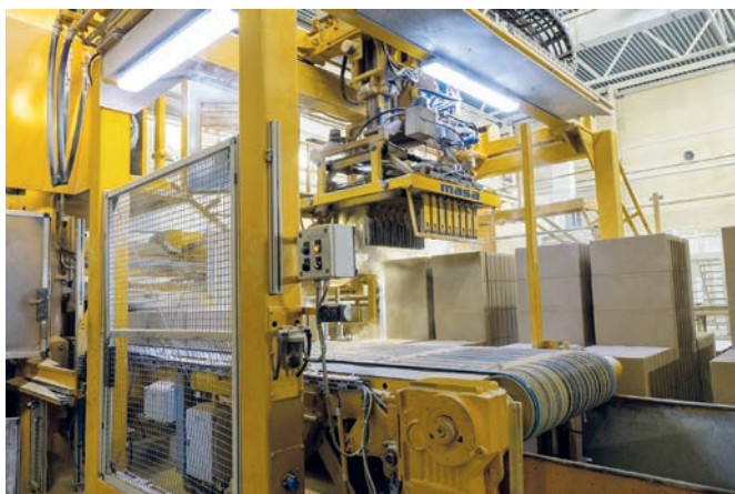
Production de briques silico-calcaires avec la presse hydraulique Masa HDP 800
