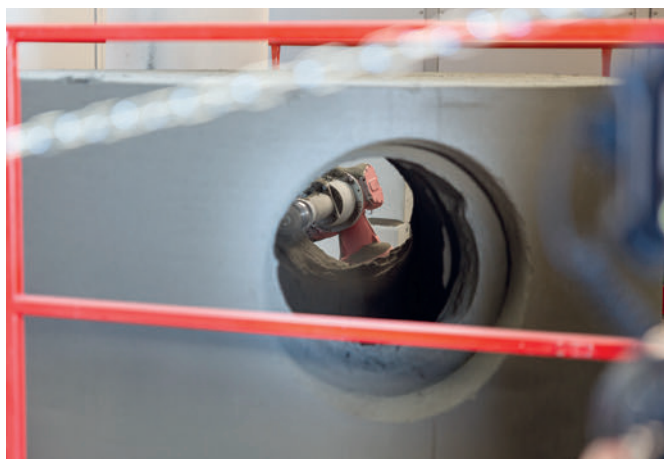
Fresado de hormigón con precisión milimétrica, con 2 diferentes cabezales de fresado: a la derecha para la canaleta y a la izquierda para entradas y salidas
