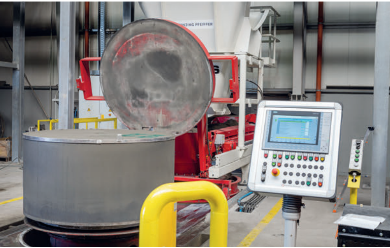
Base de pozo fresca (pieza en bruto) tras el desencofrado
