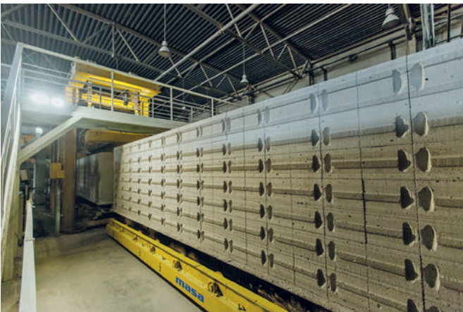
Producción de ladrillos silico-calcareos con la prensa hidráulica HDP 800 de Masa
