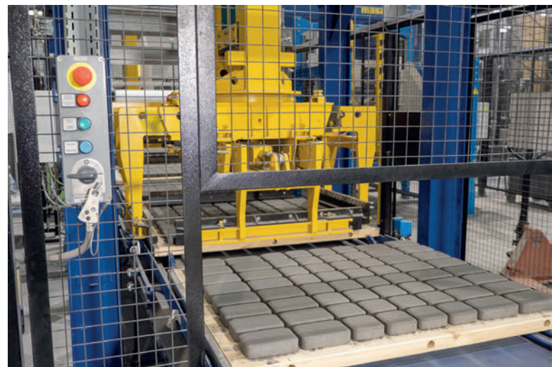
Dispositivo de centrado servocontrolado de Masa con pinza de centrado de 4 lados
