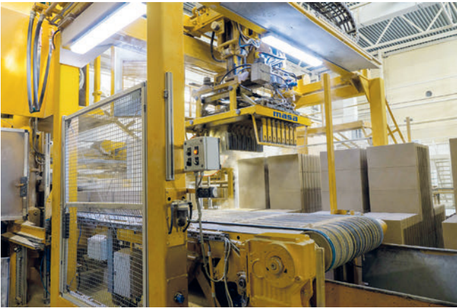
Producción de ladrillos silico-calcareos con la prensa hidráulica HDP 800 de Masa
