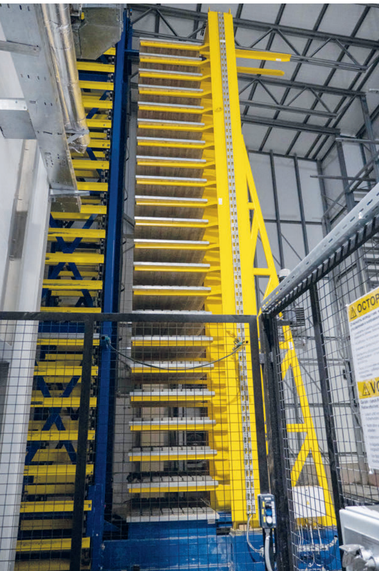
Proceso de trabajo continuo gracias al carro multiforca de almacenamiento intermedio de Masa en el lado seco
