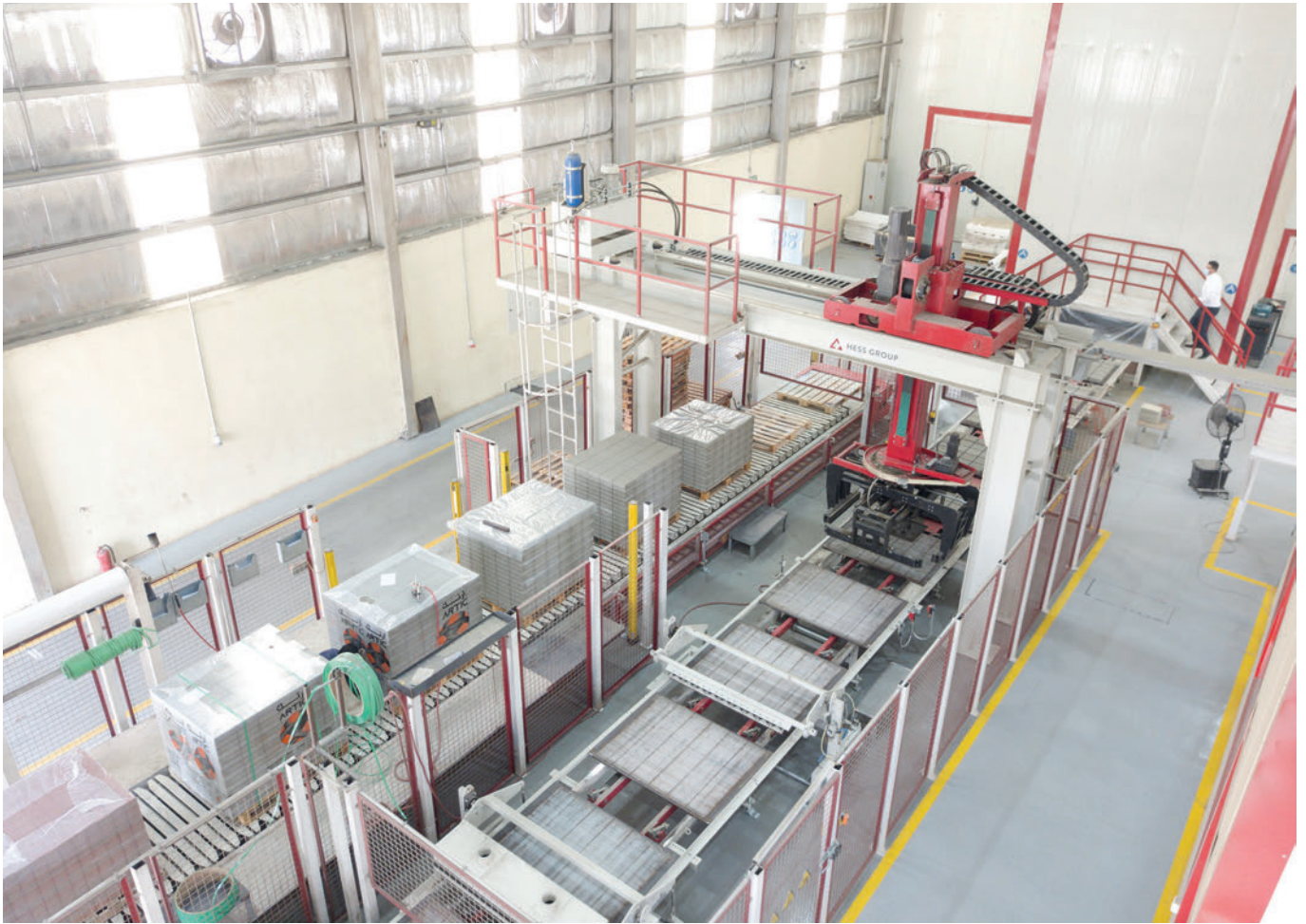
Los paquetes de bloques se forman sobre una pista de almas de 28 m de longitud dispuesta en paralelo y luego se transportan por ciclos a la zona exterior.
