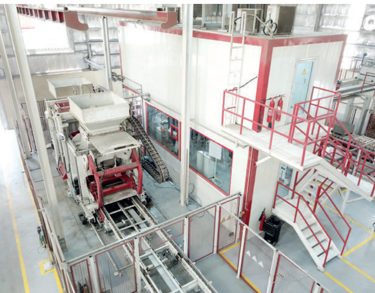
El corazón de la nueva línea de producción es la máquina de producción de bloques Multimat RH 1500-4.
