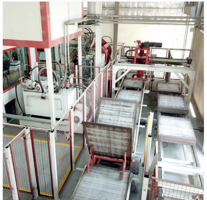
Transportador transversal con equipo de volteo de bandejas (I) y cinta intermedia de bandejas; al fondo el apilador magnético
