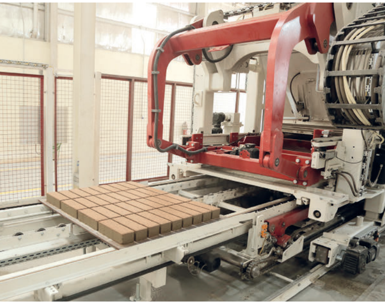
Se produce sobre bandejas de acero de 1400 x 1100 x 14 mm.
