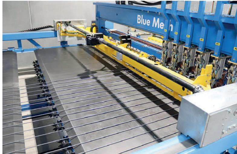
La instalación de soldadura de mallas suelta mallas de armadura individuales just-in-time.
