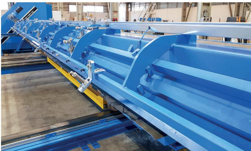
La salida de hierro longitudinal con 2 compuertas de salida y 10 m de longitud recoge las barras cortadas y las coloca en posición para el transporte posterior igualmente automatizado a la instalación de soldadura.
