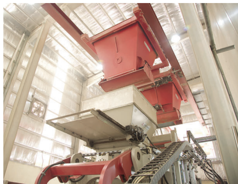
Die Doppelkübelbahn übergibt den Kern- und den Vorsatzbeton in die entsprechenden Vorratssilos der Betonsteinmaschine.
