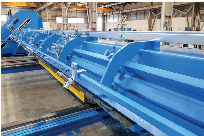
Der Längseisen-Auslauf mit zwei Auslaufklappen und 10 m Länge fängt die geschnittenen Stäbe auf und bringt sie in Position für den ebenfalls automatisierten Weitertransport zur Schweißung.
