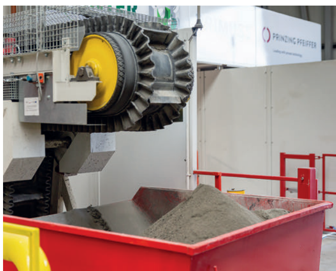
Das Restmaterial wird hochgefördert und kann erneut bei der Produktion eingesetzt werden.
