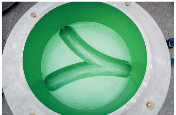
Millimetergenaues Betonfräsen mit 2 verschiedenen Fräsköpfen: rechts für das Gerinne und links für Ein- und Ausläufe
