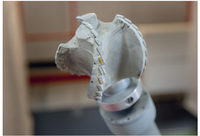
Millimetergenaues Betonfräsen mit 2 verschiedenen Fräsköpfen: rechts für das Gerinne und links für Ein- und Ausläufe
