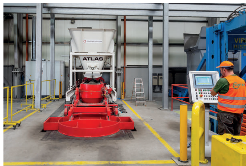
Die flexible Fertigungsanlage Atlas für die Herstellung der Schachtprodukte
