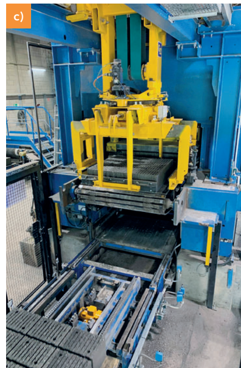
Разделитель блоков и перестановщик слоев I: набравшие прочность блоки с теплоизоляцией снимаются с технологического поддона, центрируются и аккуратно укладываются на подающую ленту шлифовальной установки
