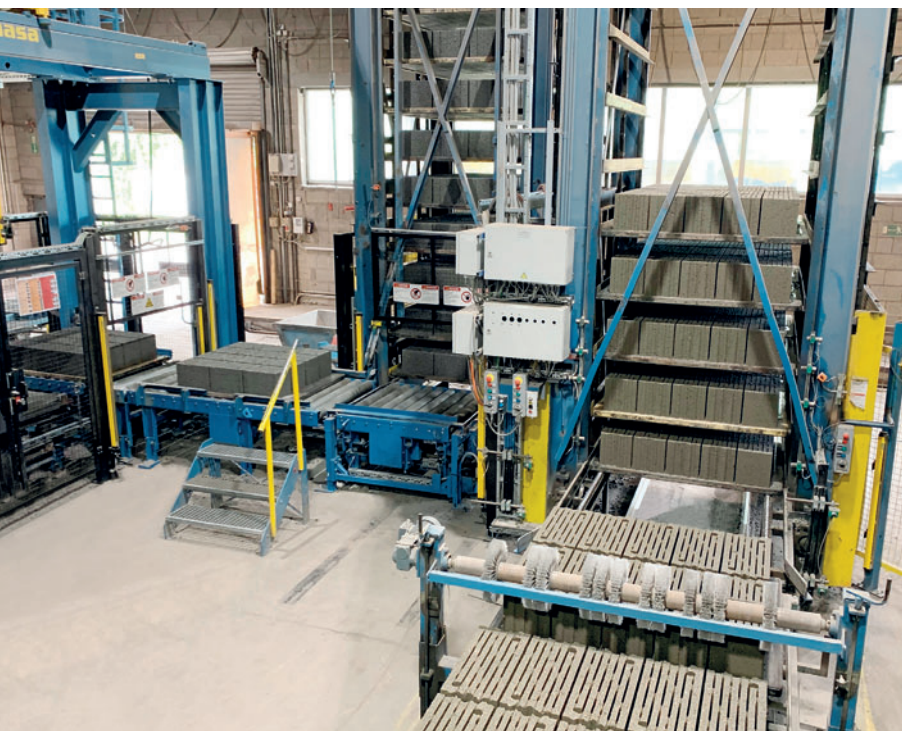
Транспортировка свежесформованных блоков с теплоизоляцией в зону выдержки или затвердевших блоков через обходные модули к шлифовальной установке
