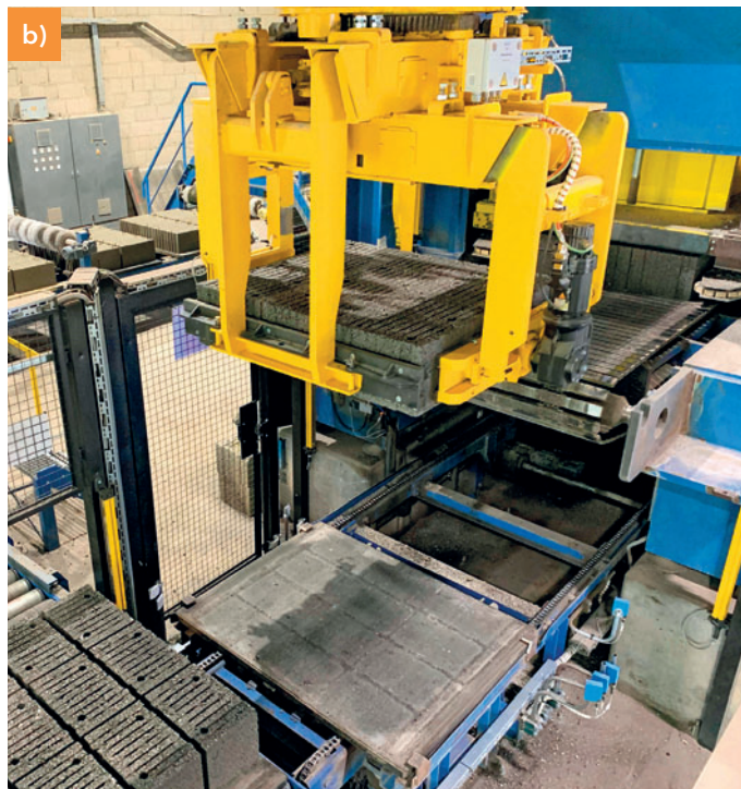
Разделитель блоков и перестановщик слоев I: набравшие прочность блоки с теплоизоляцией снимаются с технологического поддона, центрируются и аккуратно укладываются на подающую ленту шлифовальной установки
