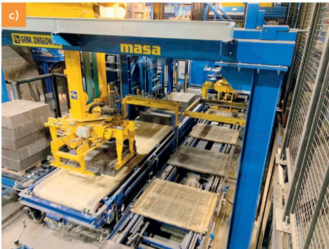
Станция переформирования Masa: первоначальные десять теплоизоляционных блоков (теплоизоляционные блоки 16DF KLB SW1) производственного цикла сокращаются до восьми блоков под размер поддона
