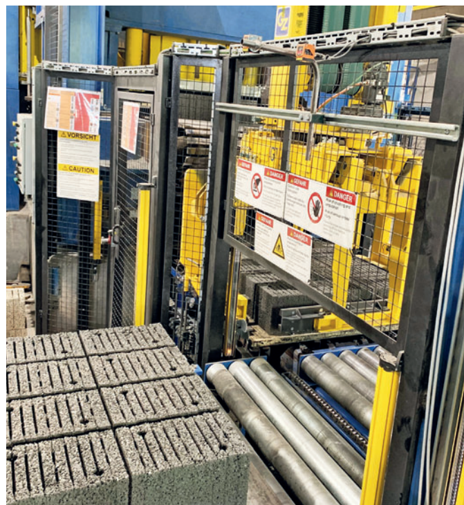
Транспортировка свежесформованных блоков с теплоизоляцией в зону выдержки или затвердевших блоков через обходные модули к шлифовальной установке
