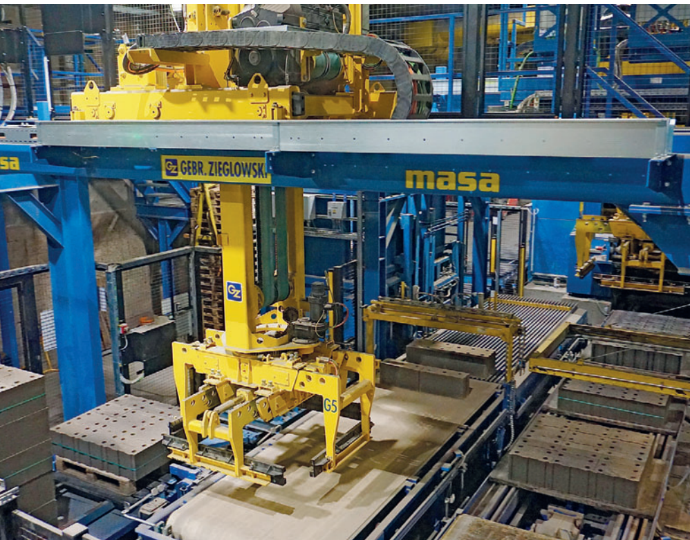
Интеллектуальное взаимодействие обратного транспортера, перестановщика слоев, линии переформирования и станции кубирования
