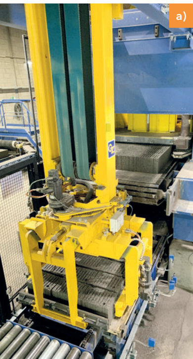
Разделитель блоков и перестановщик слоев I: набравшие прочность блоки с теплоизоляцией снимаются с технологического поддона, центрируются и аккуратно укладываются на подающую ленту шлифовальной установки
