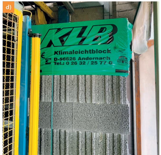
Станция переформирования Masa: первоначальные десять теплоизоляционных блоков (теплоизоляционные блоки 16DF KLB SW1) производственного цикла сокращаются до восьми блоков под размер поддона
