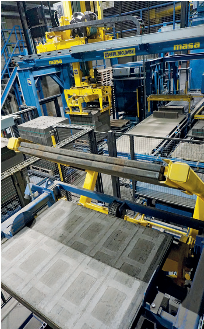
Z-образный кантователь зажимает одновременно два технологических поддона и поворачивает их на 180°
