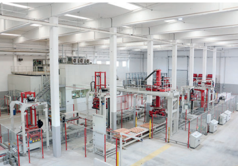
Станция упаковки на заводе Siprem: обжимное устройство, дублер и брикетировщик
