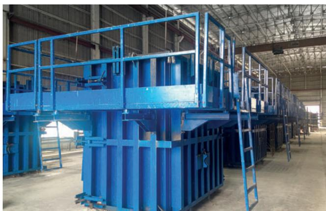
Сборные ж/б сантехнические блоки изготавливаются при помощи полностью автоматической системы форм Progress Group. Они бетонуются сверху вниз или через боковую стенку с использованием насоса
