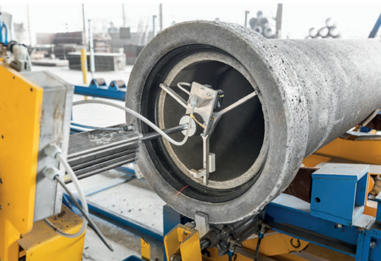
Измерение гладкого конца и прямолинейности трубы на последней станции испытательной линии
