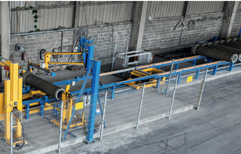
После испытаний трубы могут временно складироваться на конвейере
