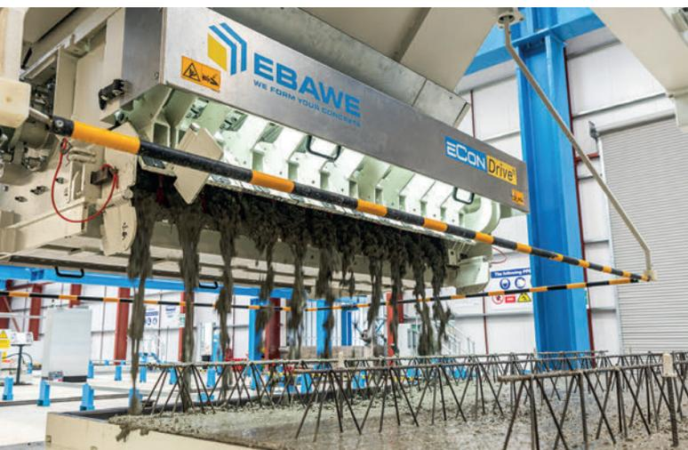
*Con il distributore automatico di calcestruzzo eCon Drive®, collegato alle soluzioni software del moderno impianto, la quantità di calcestruzzo distribuito viene calcolata con precisione e si riduce lo scarto.*
