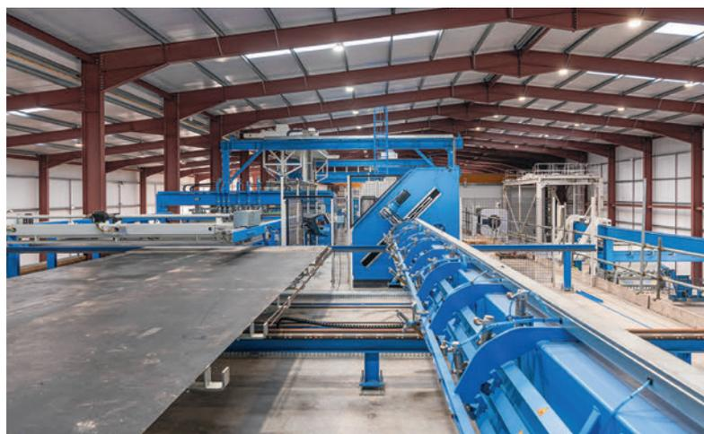
*L'impianto di saldatura reti M-System BlueMesh® provvede ad una produzione rapida dell'armatura per gli elementi prefabbricati prodotti.*
