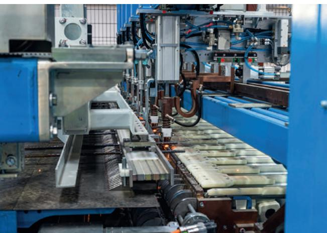
*Anche la produzione senza scarti di filo longitudinale e trasversale, direttamente dal coil, senza taglio a misura delle reti e senza operazioni di posa, ottimizza lo svolgimento della produzione.*
