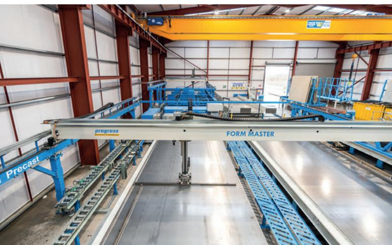
*Il robot fermagetti Form Master posiziona in modo completamente automatico e preciso le casseforme sul pallet, senza elementi riempitivi, che poi andrebbero smaltiti.*
