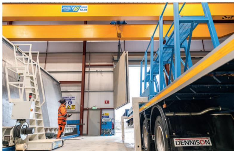
*Gli elementi per pareti vengono sollevati con un ponte ribaltatore con scala mobile, cosa che semplifica all'operatore la sformatura.*
