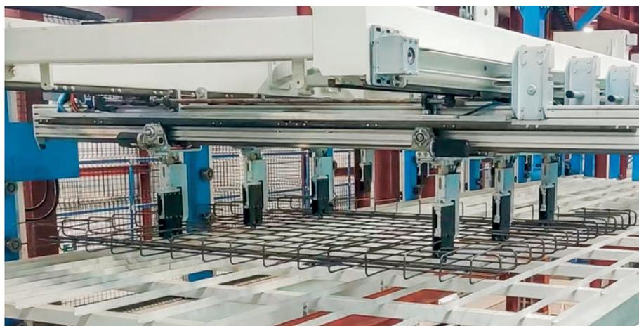
*L'innovativa traversa di presa automatizza il processo di logistica anche per reti e gabbie piegate in modo specifico*
