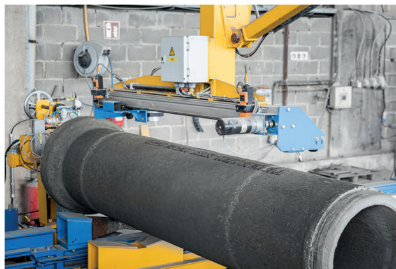
Applicazione della scritta su un tubo in calcestruzzo controllato con la stazione di marcatura
