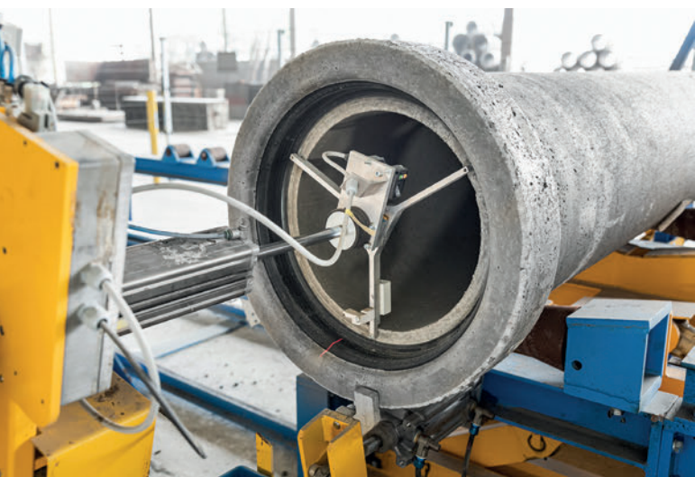
Misurazione dell'imbocco maschio e della rettilinearità nell'ultima stazione della linea di controllo
