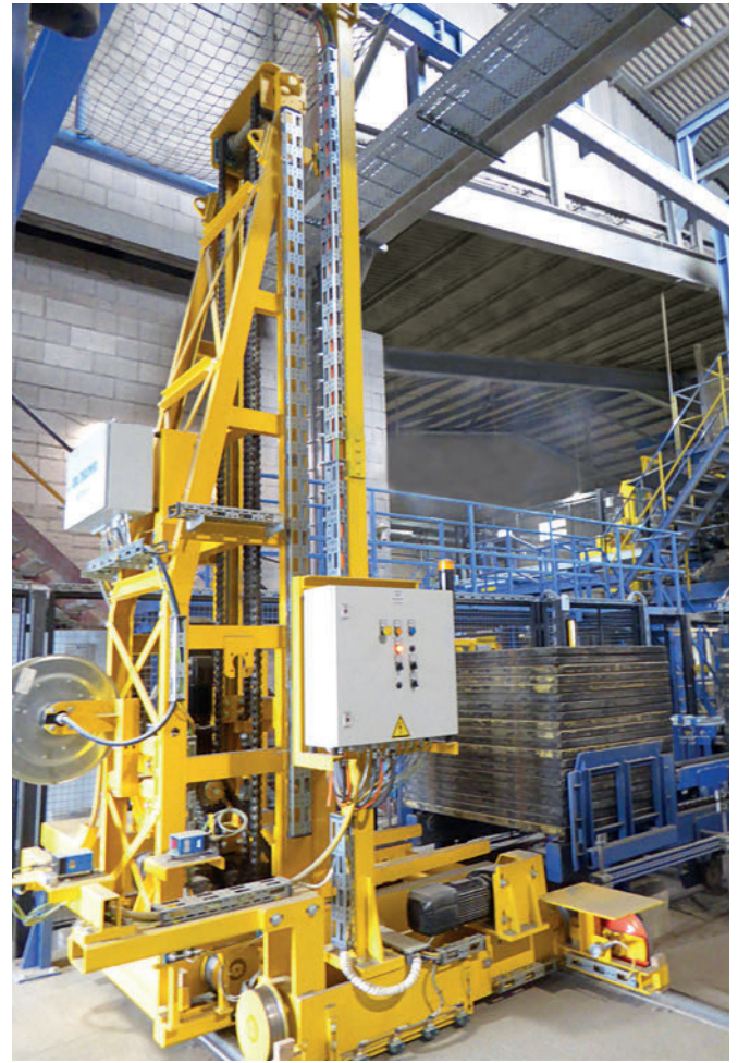
Il nuovo carrello per il trasporto del pacchetto di pannelli
