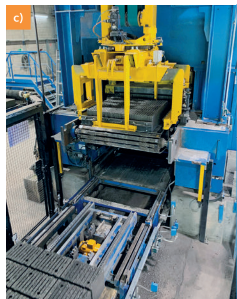
Dispositivo per staccare i blocchi e unità di spostamento strati I: i blocchi di isolamento termico stagionati vengono staccati dal pannello di appoggio, centrati e posizionati delicatamente sul nastro di alimentazione della rettificatrice.
