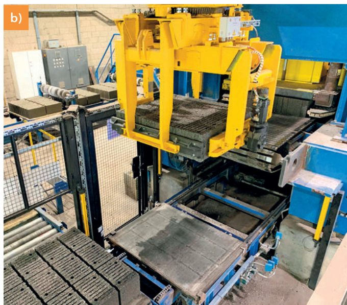
Dispositivo per staccare i blocchi e unità di spostamento strati I: i blocchi di isolamento termico stagionati vengono staccati dal pannello di appoggio, centrati e posizionati delicatamente sul nastro di alimentazione della rettificatrice.
