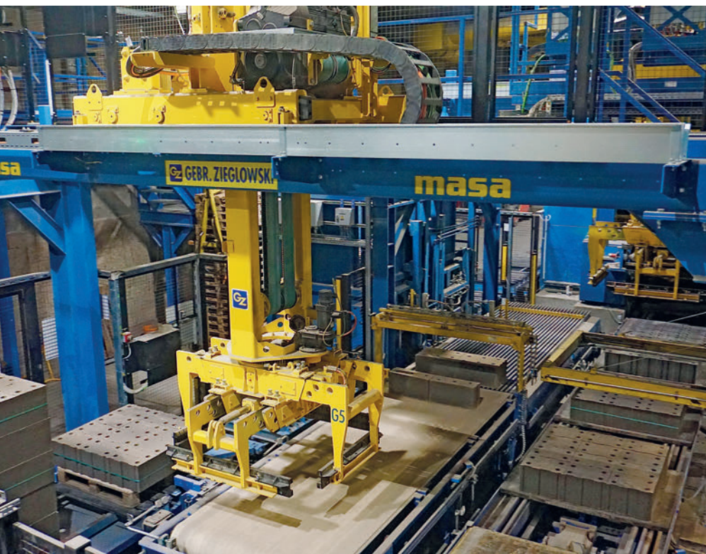
Interazione intelligente tra trasporto di ritorno, unità di spostamento strati, linea di raggruppamento e Cuboter.
