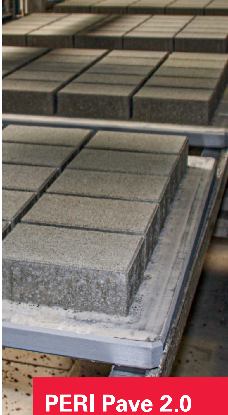
Prelievo dei prodotti rettificati e spostamento per strati sul trasporto di ritorno
