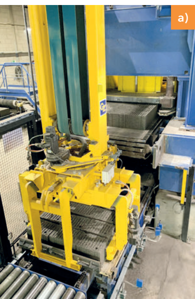
Dispositivo per staccare i blocchi e unità di spostamento strati I: i blocchi di isolamento termico stagionati vengono staccati dal pannello di appoggio, centrati e posizionati delicatamente sul nastro di alimentazione della rettificatrice.
