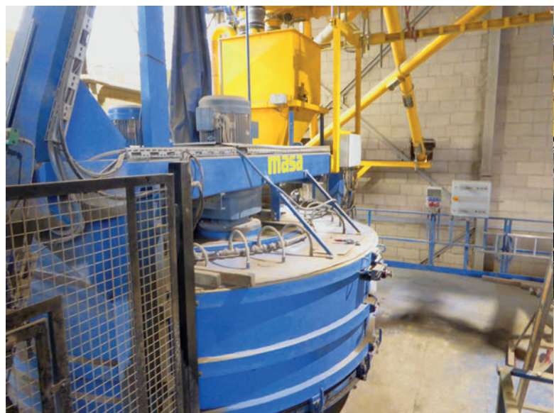
Miscelatore PH 3000/4500 per il calcestruzzo per lo strato interno
