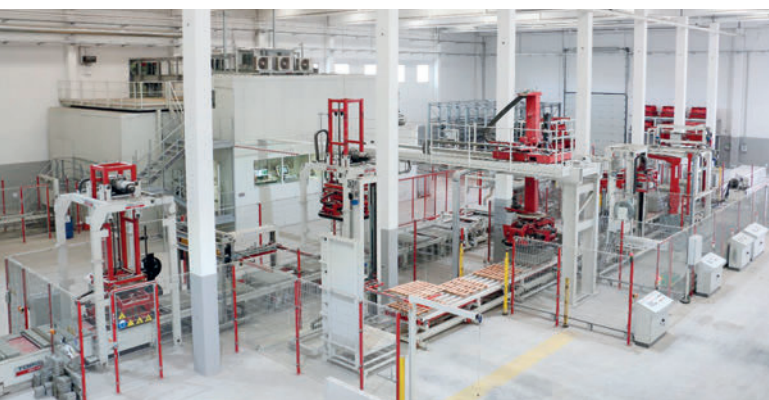
Imballaggio sulla linea del secco in Siprem: accostatore, doppiatore di blocchi e impacchettatrice
