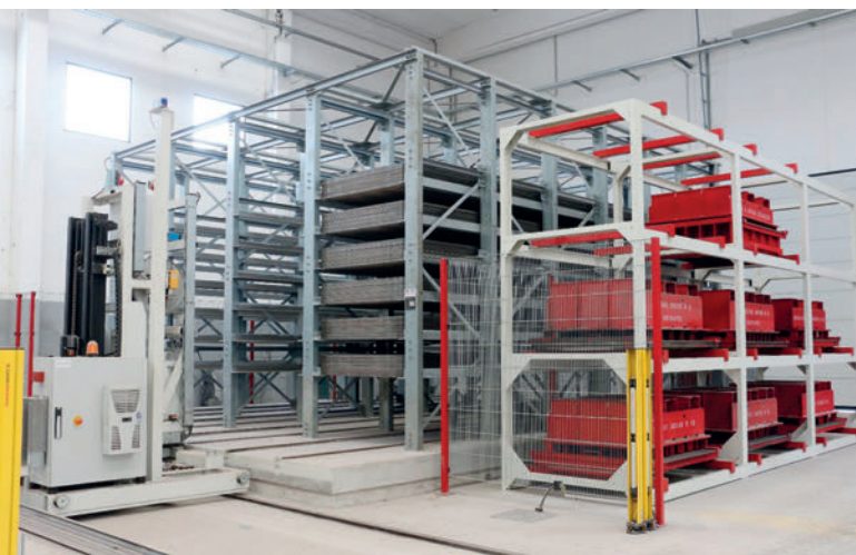
Carrello multi-forche di accumulo piastre con unità di rotazione
