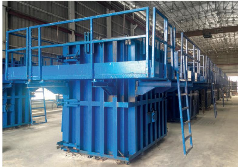
*Le PBU sono realizzate in un sistema di cassetteria completamente automatico del Progress Group. Possono essere riempite da un sistema di pompaggio dall'alto oppure lateralmente.*
