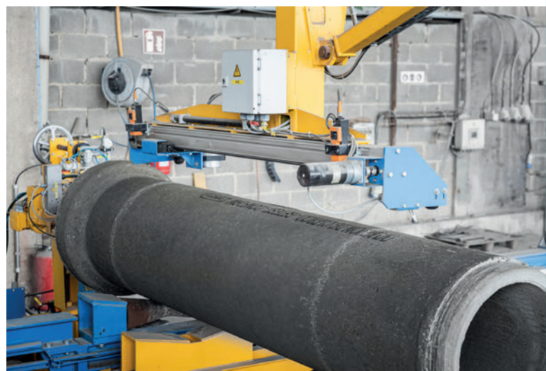
Marquage d'un tuyau en béton testé avec la station de marquage des tuyaux
