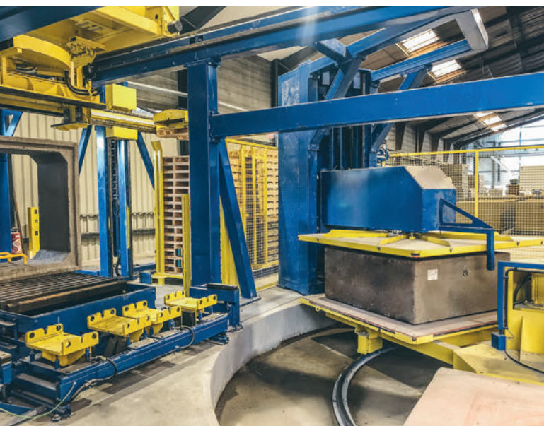
Aperçu sur le palettiseur du carrousel avec la station de contrôle d'étanchéité.
