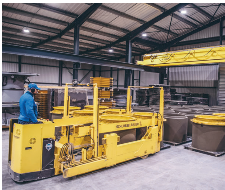
Le chariot électrique dépose les produits sur la zone de séchage avant de les reprendre plus tard pour les apporter au palettiseur.
