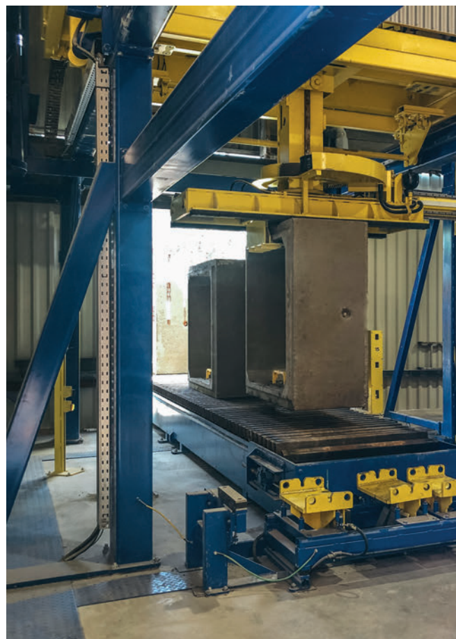
Aperçu sur le palettiseur du carrousel avec la station de contrôle d'étanchéité.
