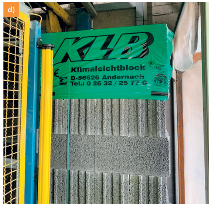
Regroupement Masa : les dix blocs isolants originaux (blocs isolants 16DF KLB SW1) du cycle de production sont réduits à huit blocs pour atteindre la taille de la palette.
