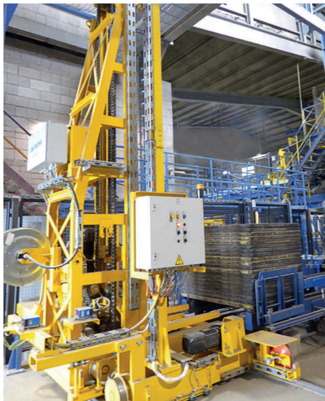
Le nouveau chariot de transport de paquets de planches Masa
