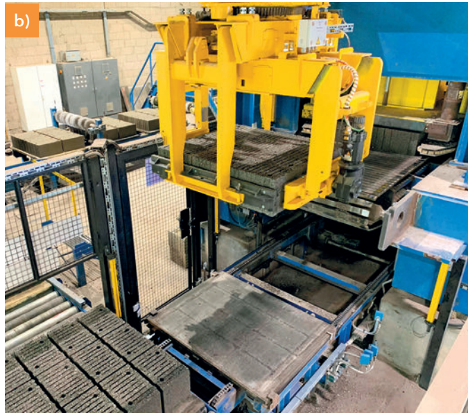
Séparateur de blocs et translateur de couche I : les blocs isolants durcis sont séparés de la planche de support, centrés et placés délicatement sur le convoyeur d'alimentation de la rectifieuse.
