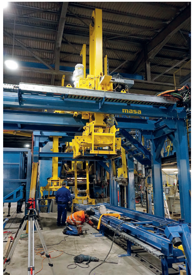
Pendant la phase de conversion : montage du transport de retour, des translateurs de couches III et IV, ainsi que du Cuboter.
