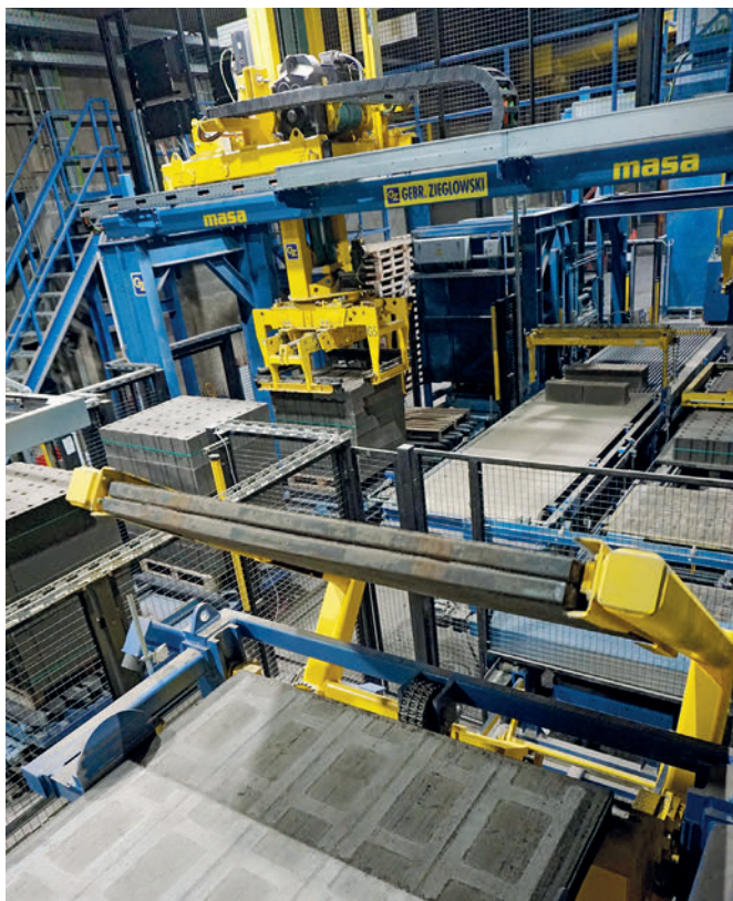
Le dispositif de retournement Z serre deux planches de support et les tourne à 180°.
