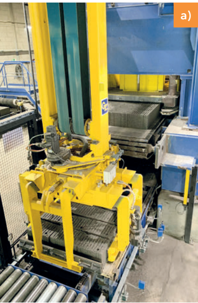
Séparateur de blocs et translateur de couche I : les blocs isolants durcis sont séparés de la planche de support, centrés et placés délicatement sur le convoyeur d'alimentation de la rectifieuse.
