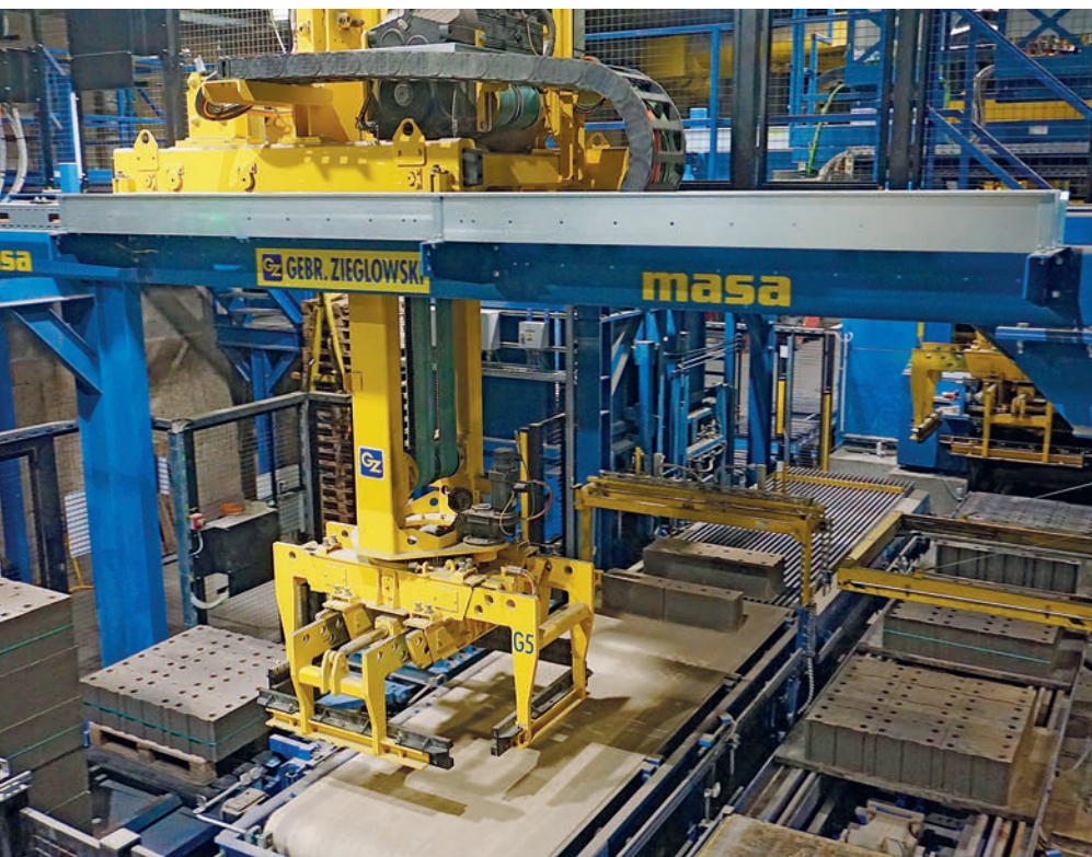
Interaction intelligente du transport de retour, du translateur de couche, de la ligne de regroupement et du Cuboter.
