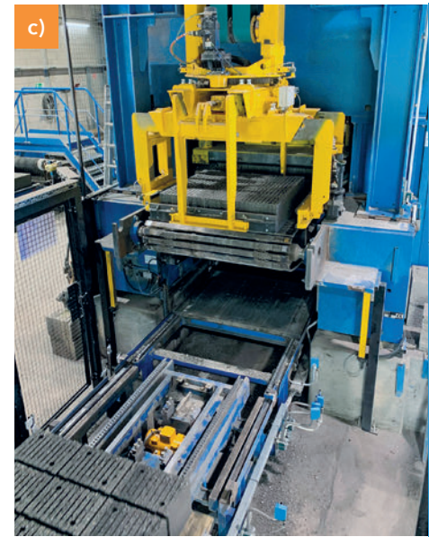
Séparateur de blocs et translateur de couche I : les blocs isolants durcis sont séparés de la planche de support, centrés et placés délicatement sur le convoyeur d'alimentation de la rectifieuse.
