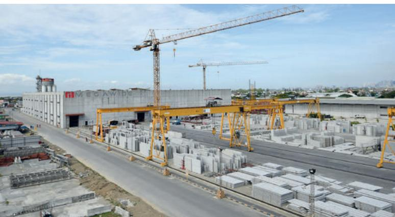
*La production d'éléments préfabriqués en béton dans des usines réduit considérablement la durée des travaux de construction sur le chantier et la qualité des murs et des plafonds est constamment élevée.*
