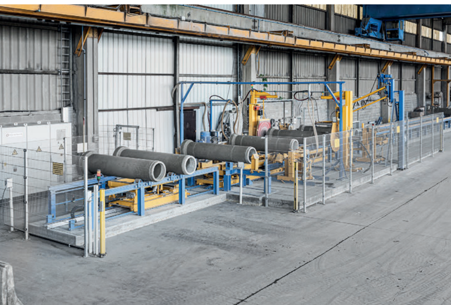
Beton De Clercq, de la ciudad belga de Gante, es una nueva planta de hormigón que apuesta por una línea de comprobación de tubos de Prinzing Pfeiffer.
