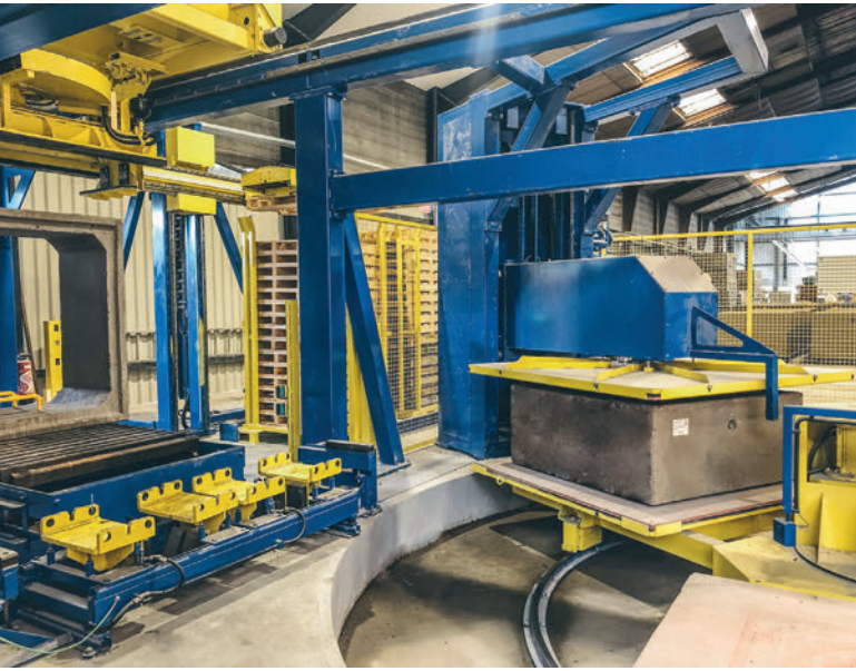
Imagen del carrusel de la instalación de paletizado con la estación de pruebas correspondiente
