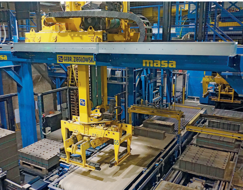
Una interacción inteligente entre transporte de retorno, desplazador de capas, línea de reconfiguración y Cuboter.
