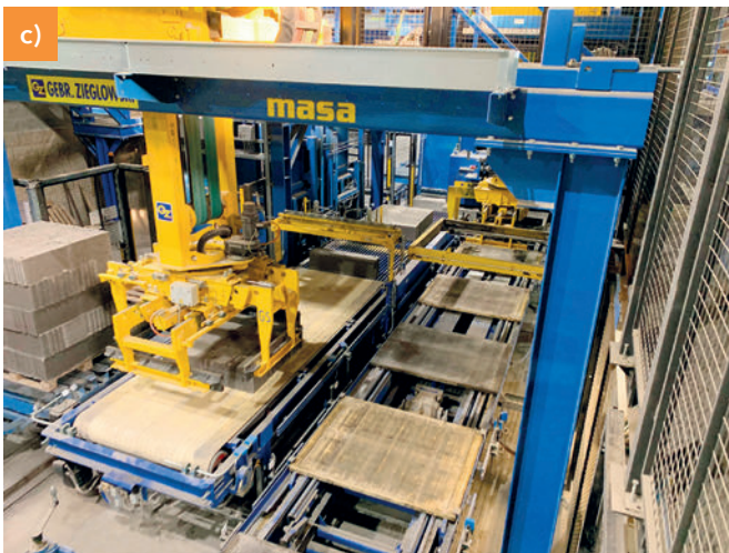
Reconfiguración Masa: Los iniciales diez bloques aislantes (bloques aislantes 16DF KLB SW1) del ciclo de producción se reducen a ocho bloques para lograr la medida del palet.
