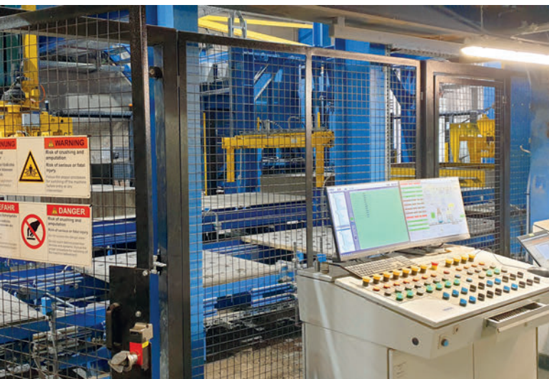
El nuevo pupitre de mando para el área de transporte de retorno y reconfiguración.
