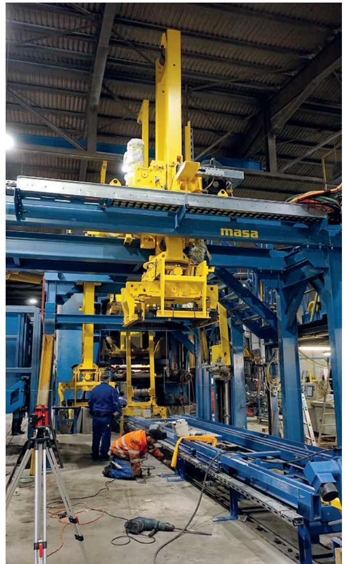
Durante la fase de remodelación: montaje y transporte de retorno, desplazador de capas III y IV, así como Cuboter.
