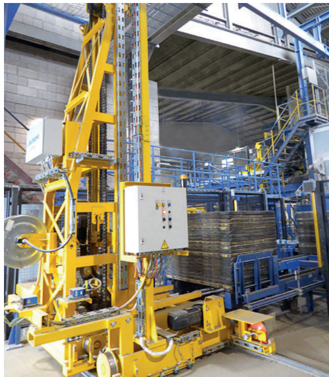
El nuevo carro transportador de paquetes de bandejas de Masa
