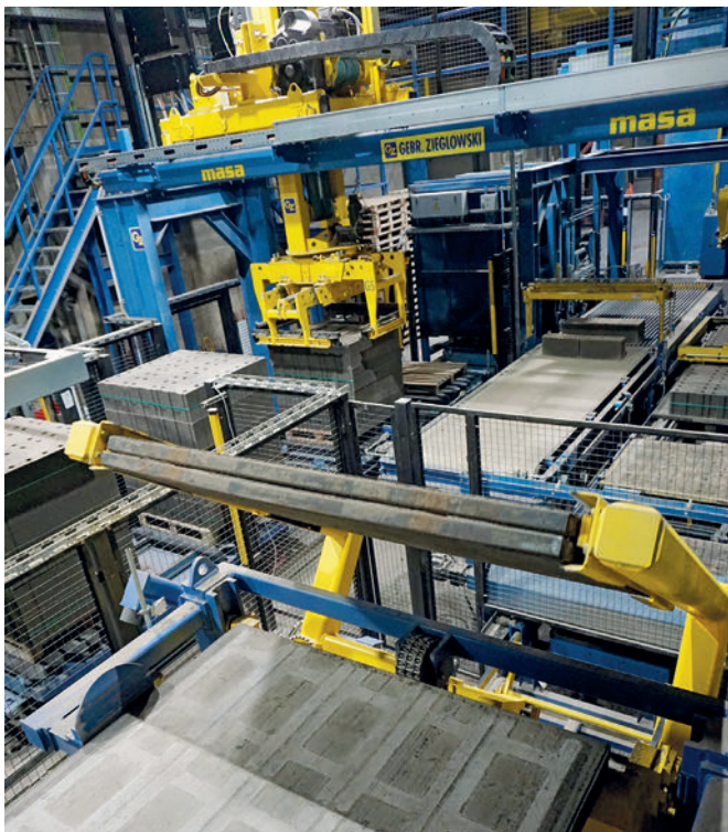
El equipo de volteo Z sujeta respectivamente dos bandejas de producción y las gira 180°.
