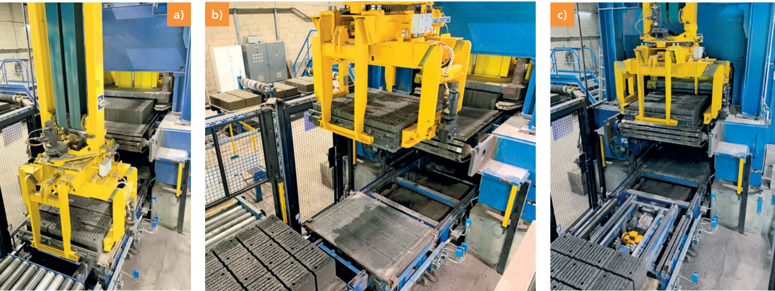
Soltador de bloques y desplazador de capas I: Los bloques aislantes curados se sueltan de la bandeja de producción, se centran y se colocan cuidadosamente sobre la cinta de alimentación de la instalación rectificadora.
