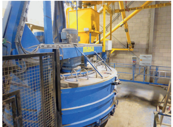
Mezclador PH 3000/4500 para hormigón monocapa
