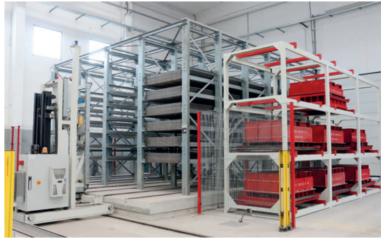
Carro multiforca de almacenamiento temporal con dispositivo de volteo para bandejas
