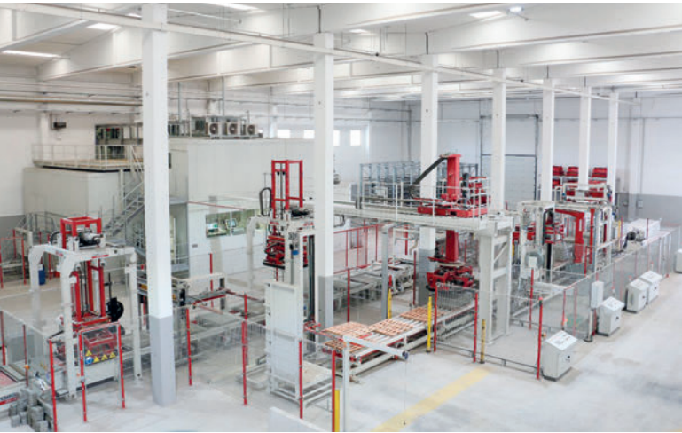
Embalaje en el lado seco en Siprem: soldador de piezas, doblador de piezas y empaquetadora
