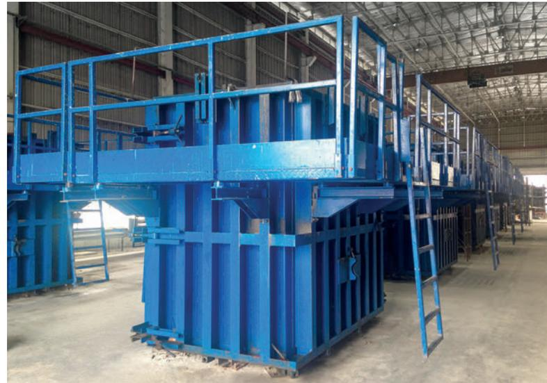
Las unidades PBU se fabrican en un sistema de encofrado completamente automático de Progress Group. Se pueden llenar por arriba o por el lateral mediante un sistema de bombeo.
