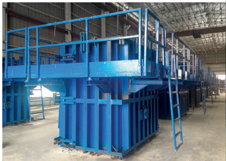
Die PBUs werden in einem vollautomatischen Schalungssystem der Progress Group hergestellt. Sie können von oben oder von der Seite durch ein Pumpsystem befüllt werden.
