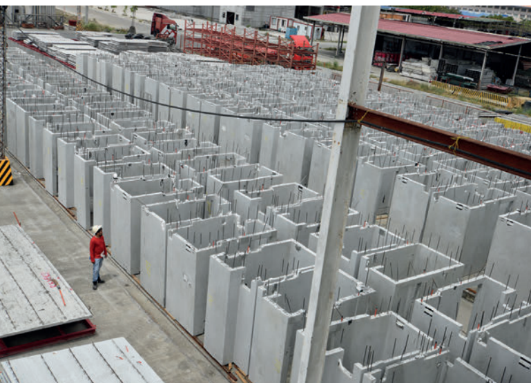
Die vorgefertigten Badezimmer-Einheiten (PBU) werden als fertige Einheit geliefert, die auf der Baustelle mit weniger Personalaufwand installiert werden kann.
