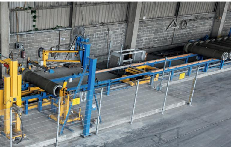
Auf der Rohrlegebahn können zahlreiche Rohre nach der Prüfung gepuffert werden.
