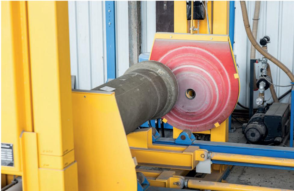
Die entgrateten Betonrohre werden im nächsten Takt der Vakuumprüfstation zugeführt.
