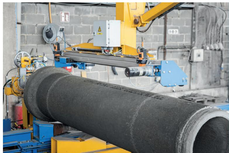
Beschriftung eines geprüften Betonrohrs mit der Rohrsignierstation
