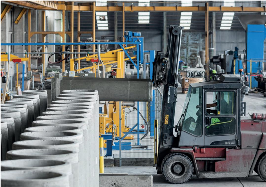
*Die Rohrprüfstraße beginnt mit der Rohrablage und Ausrichtstation*
