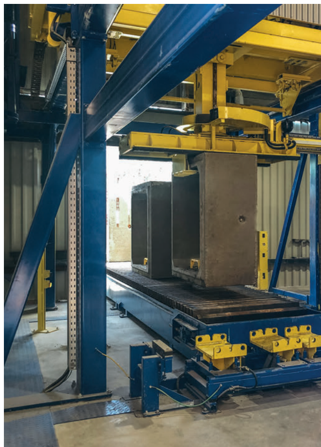
Blick auf das Karussell der Palettieranlage, mit der dazugehörigen Prüfstation
