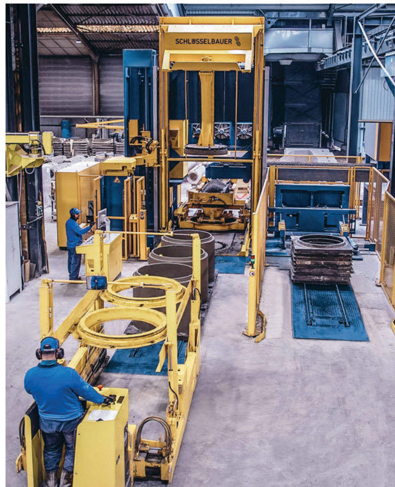
Produktionsanlage Magic von Schlüsselbauer Technology im täglichen Einsatz
