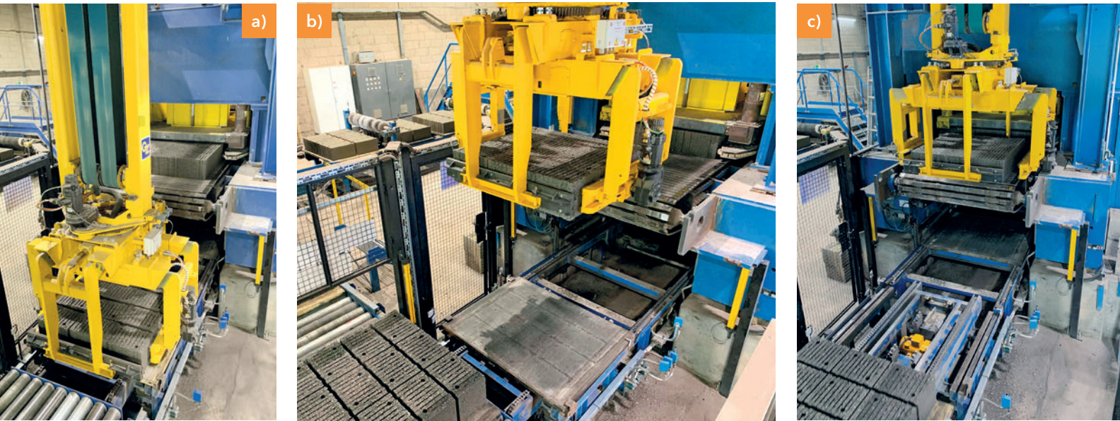
Steinlöser und Lagenumsetzer I: Die ausgehärteten Wärmedämmsteine werden von der Produktionsunterlage gelöst, zentriert und schonend auf das Zuführband der Schleifanlage gesetzt.
