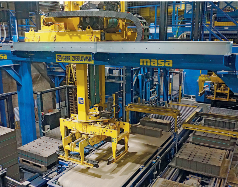
Intelligentes Zusammenspiel von Rücktransport, Lagenumsetzer, Umformierlinie und Cuboter
