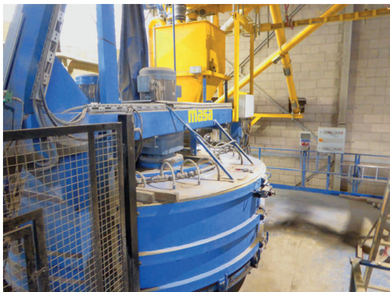
Mischer PH 3000/4500 für Kernbeton
