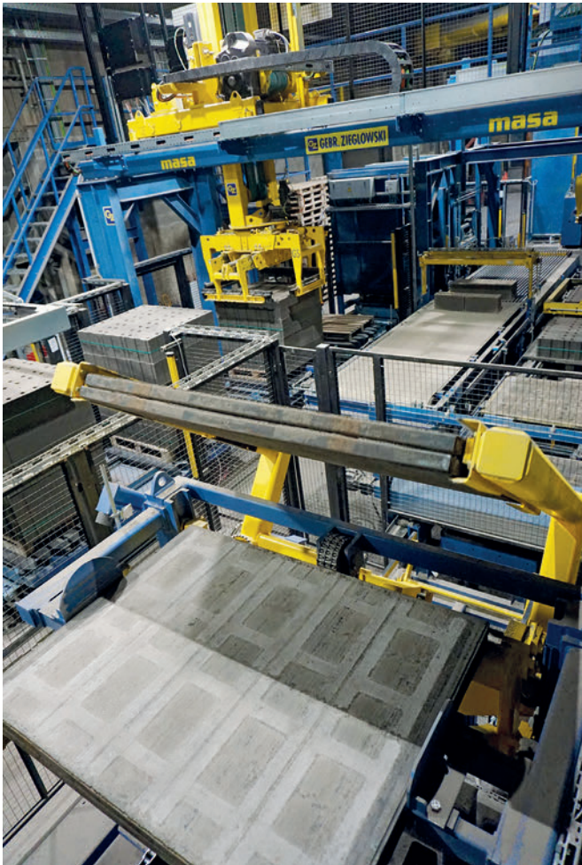
Der Z-Wender klammert je zwei Produktionsunterlagen und wendet sie um 180°.
