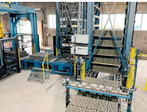
Transport von frisch produzierten Wärmedämmsteinen zum Aushärtbereich bzw. von ausgehärteten Steinen über die Bypass-Module zur Schleifanlage
