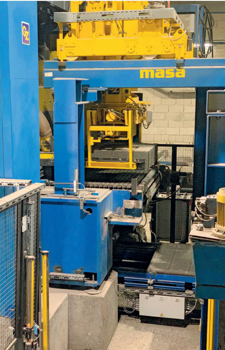
Aufnahme der geschliffenen Produkte und lagenweises Umsetzen auf den Rücktransport
