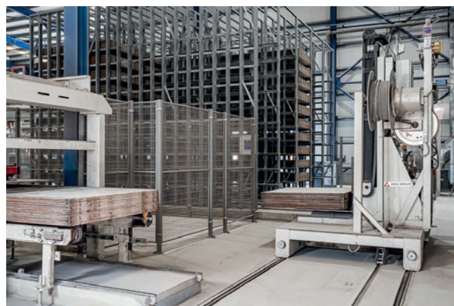
Wózek wielowidłowy do transportu stalowych podkładów produkcyjnych.
