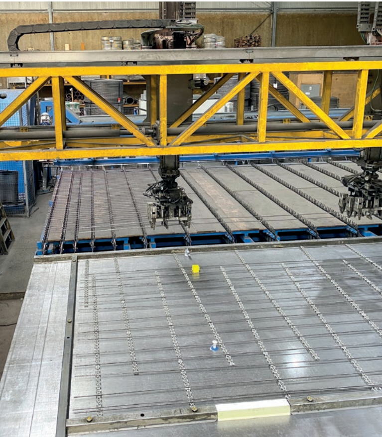
Sześciopunktowy chwytak EPT pracuje automatycznie zgodnie z danymi CAD-CAM.
