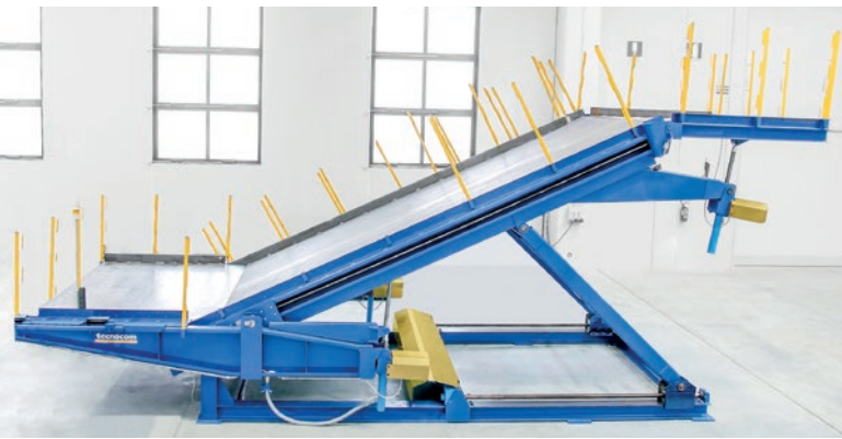
Nowa forma do schodów typu Ramp-Tec Plus.
