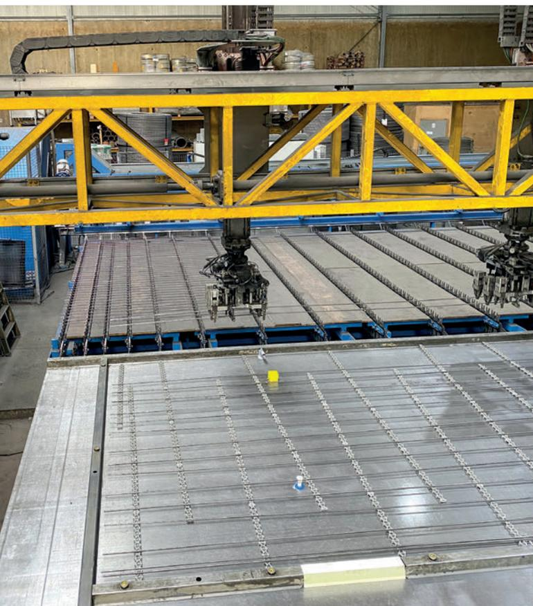
*La pinza sestupla per la posa EPT lavora in modo completamente automatico secondo specifiche CAD-CAM.*
