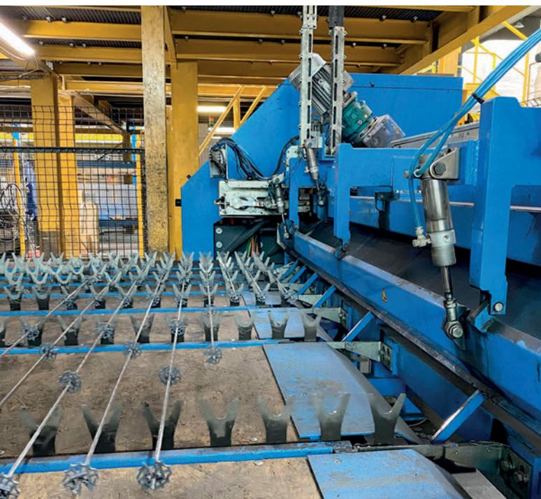
*La raddrizzatrice-tagliatrice Multirotor MSR di Progress ha un cambio automatico del diametro dei fili e un dispositivo automatico di posizionamento dei distanziatori.*
