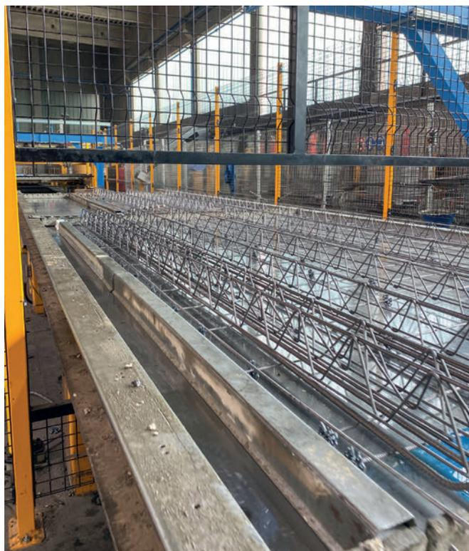
Le nuove impianti per la produzione di tralicci elettrosaldati VGA Versa sono in grado di passare da un'altezza di traliccio all'altra in pochissimo tempo, mentre è in corso la produzione.
