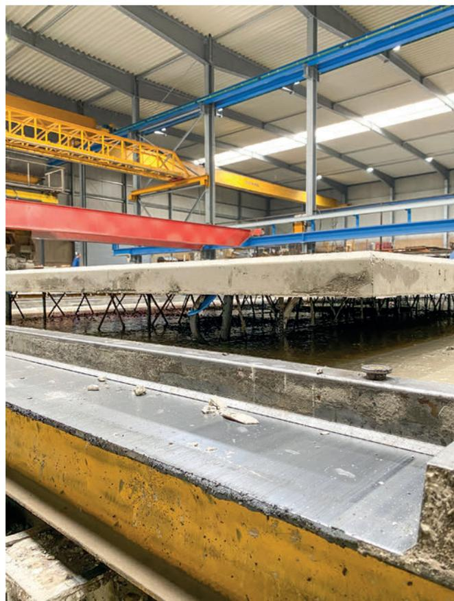
*Con i tralici prodotti, si provvede all'armatura di pareti e solai prefabbricati in calcestruzzo.*
