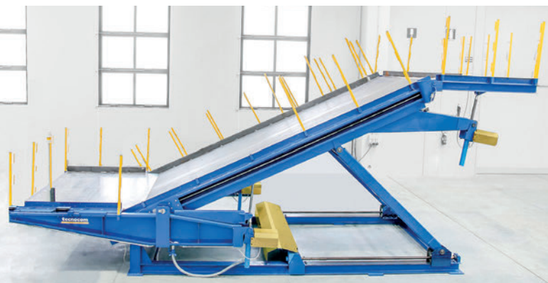
Il nuovo cassero a rampa per scale modello Ramp-Tec Plus
