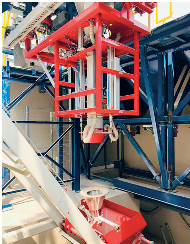
Sistema di dosaggio dei pigmenti coloranti
