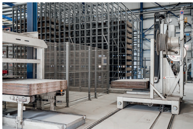
Carrello multi-forche ad accumulo di pannelli
