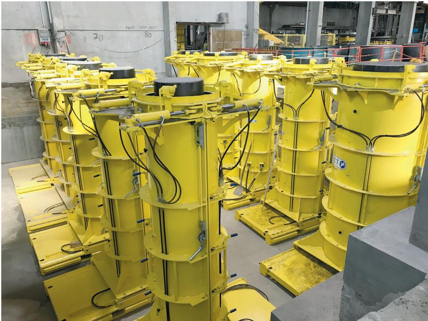
La production optimisée de tuyaux de fonçage est possible aussi bien dans le cadre d'une production spécifique pour tuyaux de fonçage que dans le cas d'équipements de moulage à intégrer à une production déjà en place de produits fabriqués en différé, avec ou sans revêtement en PEHD.
