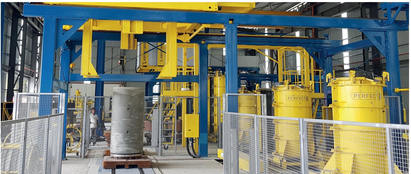
Installation automatisée spécialisée dans la fabrication de tuyaux de fonçage Perfect en Malaisie (cf. rapport détaillé paru dans le magazine PBi 02/2018).
